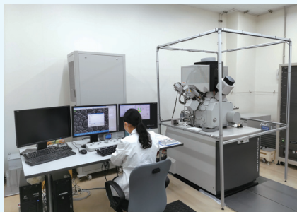
FIB-SEM装置と観察の様子
