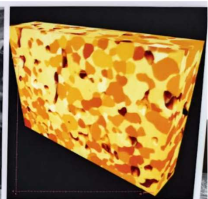
燃料電池電極 3D画像 (Slice & View機能使用)
