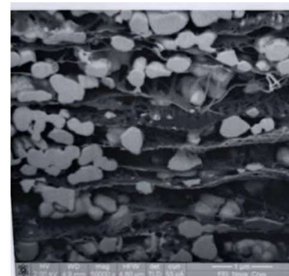
セラミックス/ポリマー複合体 FIB断面 二次電子像 (クライオステージ使用)
