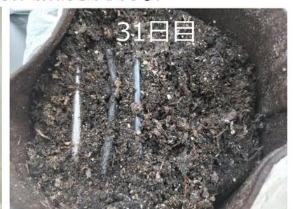
■ 相談対応例：米ストローの生分解性試験の様子
