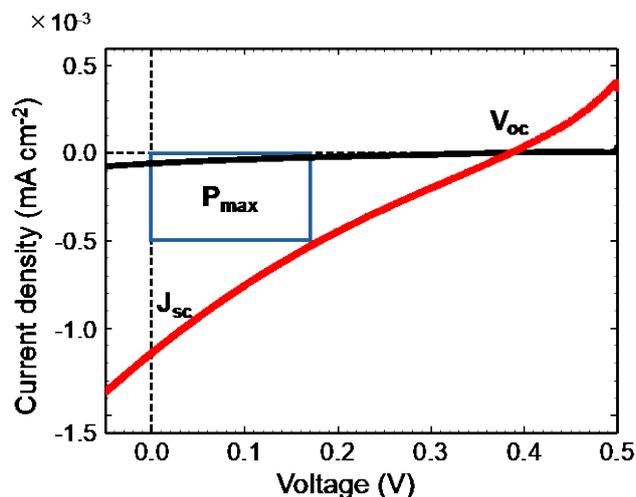
(図3) 有機熱電デバイスの J-V 特性。赤線が CuPc(180 nm)/F<sub>16</sub>CuPc(320 nm)/C<sub>60</sub>(20 nm)/BCP(20 nm)の素子特性。
