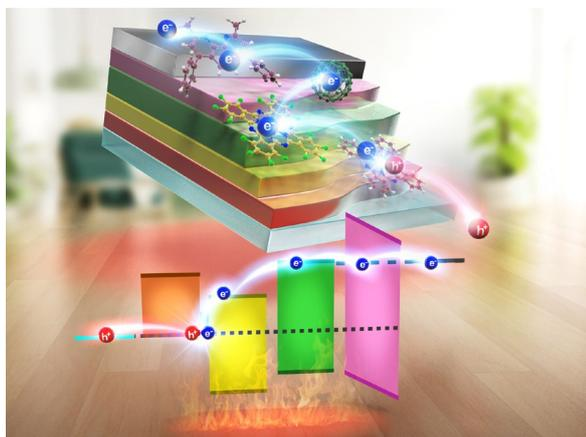
(図4) 従来エネルギー源として捉えられなかった居住環境にあふれる室温程度の熱を利用可能な電気エネルギーへ変換可能な有機熱電デバイス温度差が不要、つまり冷却部を必要としないので、コンパクトな装置になり、温度差を得にくい低温廃熱も活用できる道を拓く。
