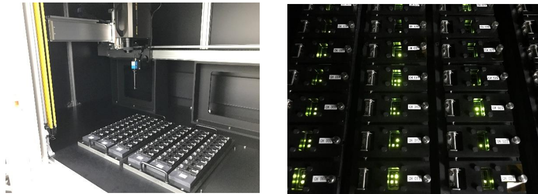
図：連続駆動寿命評価装置と装置内での有機 EL の発光の様子
