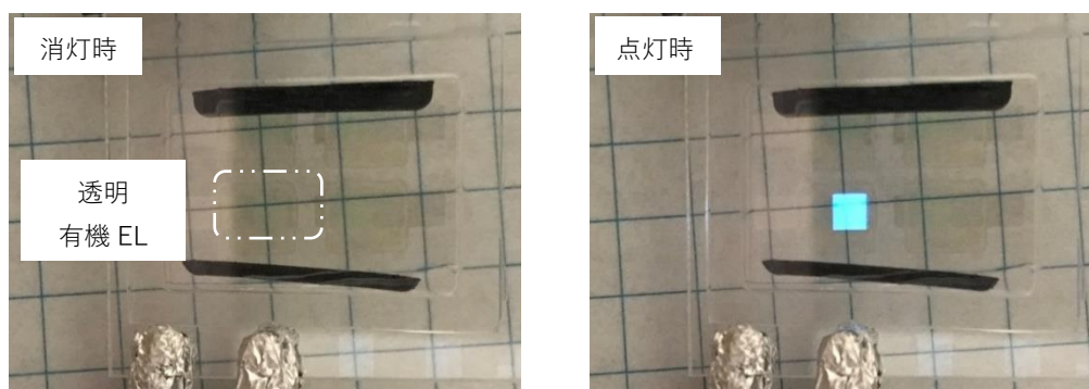
新規酸化物バッファ層を導入し、ITO 透明電極をスパッタ法で成膜した透明有機 EL 素子
