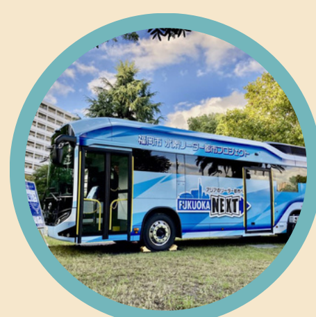
Moving e (ムービングイー) 外部給電器・バッテリー搭載の燃料電池バス
