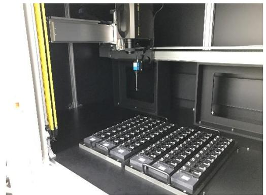
図：連続駆動寿命評価装置
