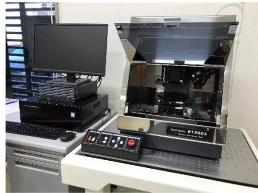
図：原子間力顕微鏡(左)と触針式表面あらさ計
