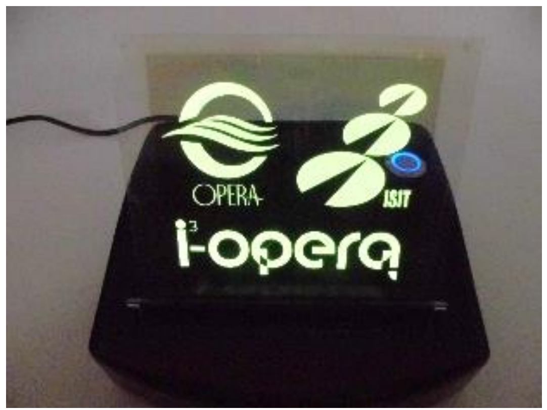
フレキシブル基板上へ作製した透明有機ELパネル
