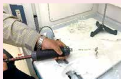
事例1：ガス検知管によるホルムアルデヒド濃度測定の様子
