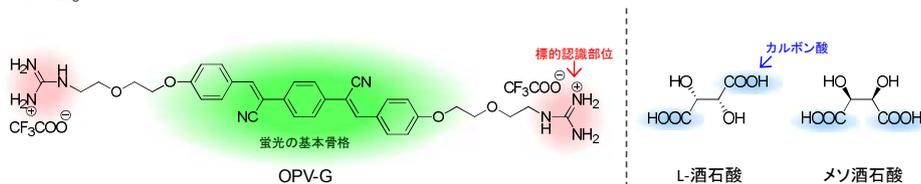
図 4：開発した蛍光プローブ (OPV-G) と酒石酸の化学構造
