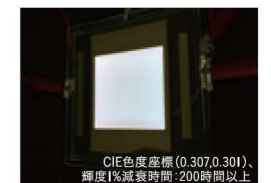
CIE色度座標(0.307,0.301)、輝度1%減衰時間>200時間以上 黄色発光TADF材料と既存の青色材料を用いたタンデム型白色有機ELデバイス
