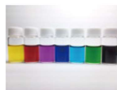
サイズの異なる銀ナノプレート分散液 (大日本塗料(株)提供)
