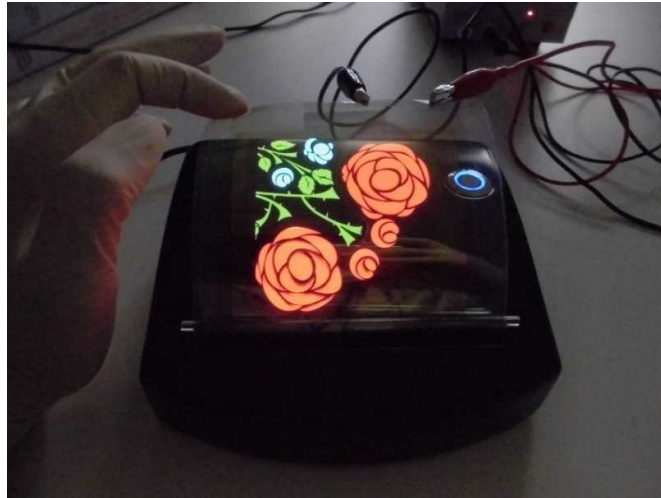
図7 評価中のフレキシブル・半透明基板有機ELデバイス（発光面積80mm角） フレキシブル基板、フレキシブル透明面封止、プロセス技術が含まれています
