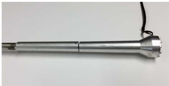
スイング診断システム：力覚センサ搭載ゴルフクラブ(左)とスイング診断の様
