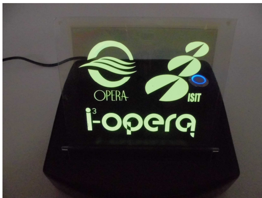
図1.1.5-7 フレキシブルかつ半透明基板の評価中の発光面積80mm角の有機ELデバイス フレキシブル基板、フレキシブル透明面封止、プロセス技術が含まれています
