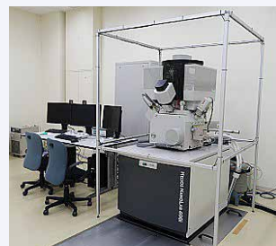
イオンビームで試料を削りながら電子顕微鏡で観察するFIB-SEM
