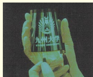
試作したフレキシブル有機EL (協力:九州大学 安達研究室)
