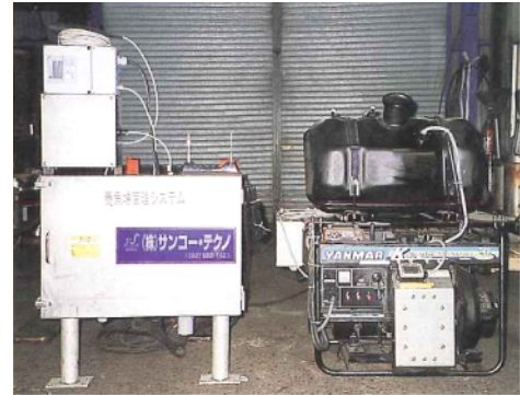
水質管理システムと発電機
