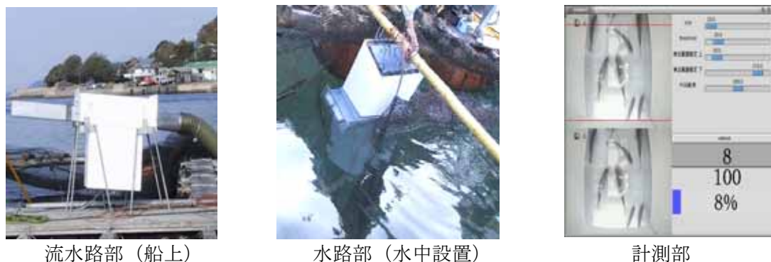
写真6-1 実時間画像処理技術の応用例「養魚場における稚魚数計測システムの開発」
