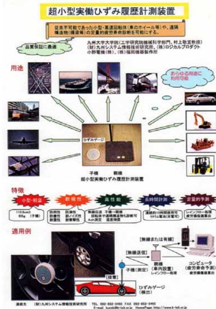
図2-6 超小型実働ひずみ履歴計測装置とその応用例
